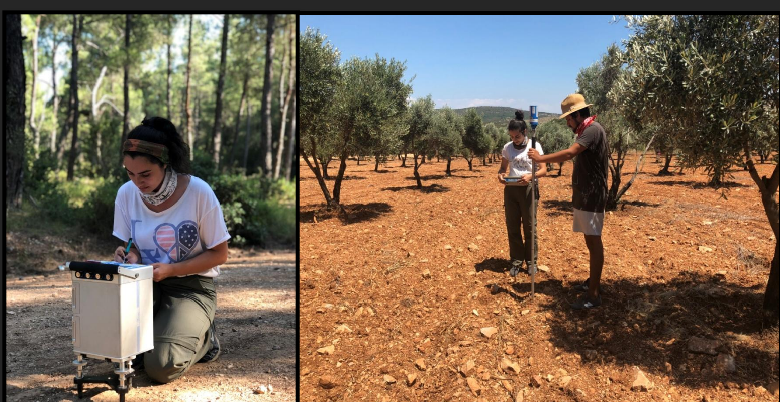
Şekil 2. Arazide gravite ve manyetik ölçümlerine ait fotoğraflar
