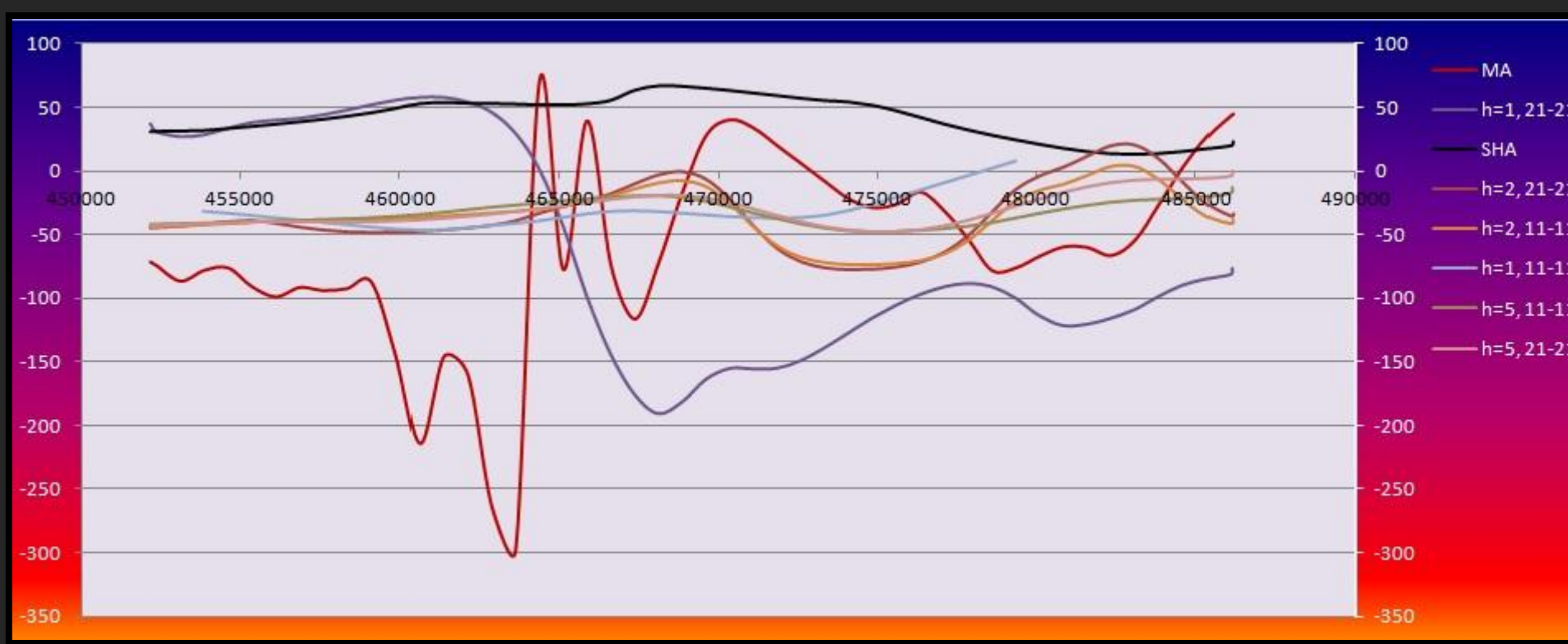
Şekil 9. A-A' profiline ait serbest hava gravite anomalisi, manyetik anomali ve farklı filtre katsayıları ile süzgeçlenmiş manyetik anomalileri
