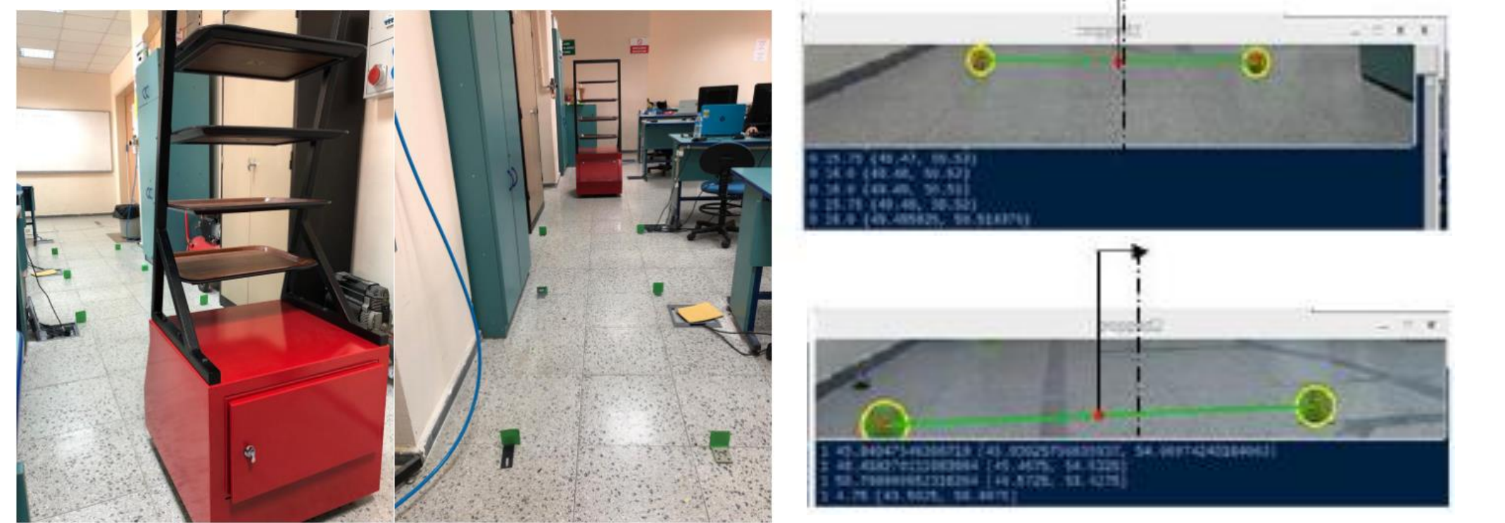
Şekil 11. a) Robotun ve işaretlerin konumları b) Kamera ile işaretlerin algılanması
