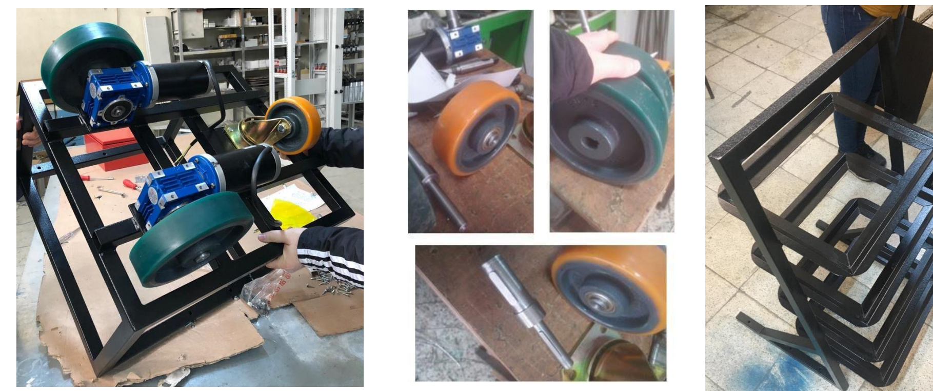
Şekil 9. Mobil robotun prototip üretimi
