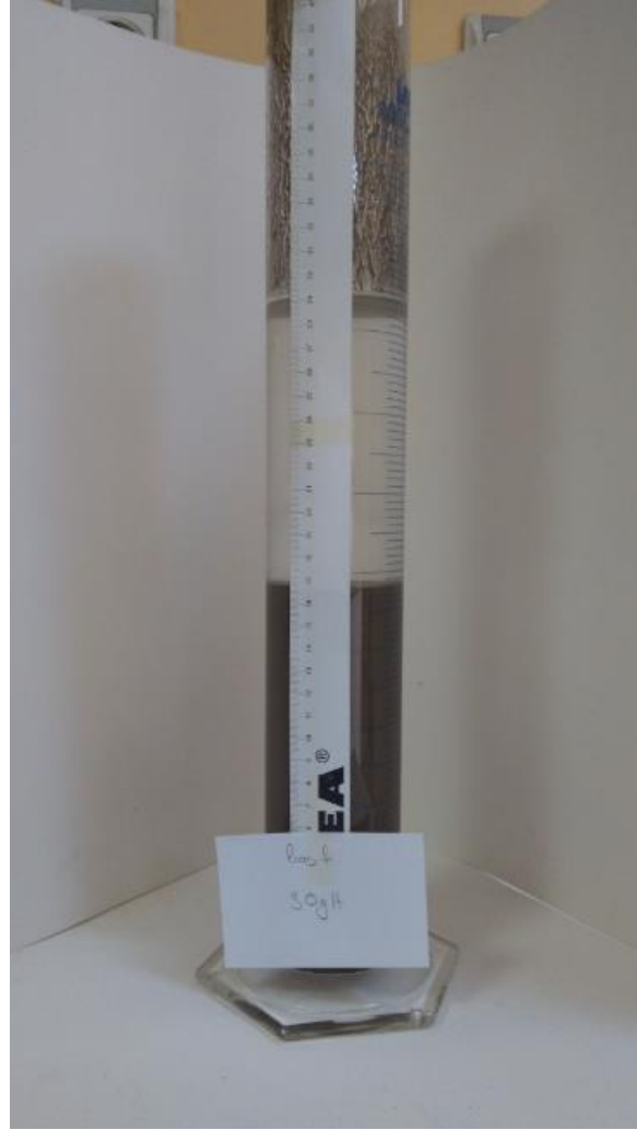
Şekil 17. BASF, 30 g/t uygulama sonrası karşıdan görünüm
