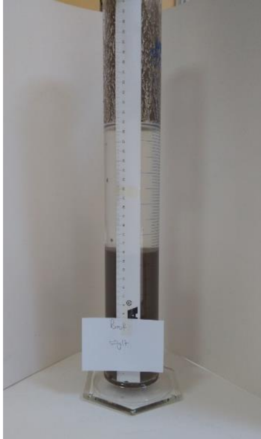
Şekil 19. BASF, 50 g/t uygulama sonrası karşıdan görünüm
