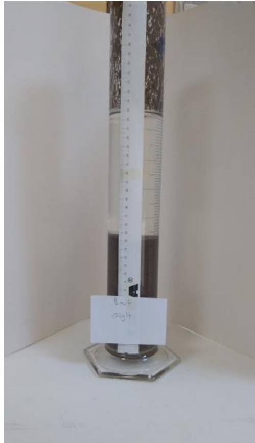
Şekil 21. BASF, 100 g/t uygulama sonrası karşıdan görünüm
