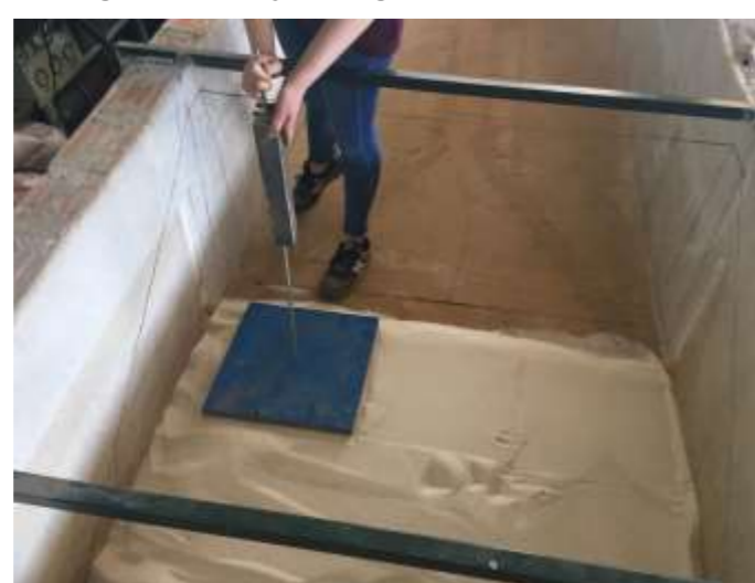
Şekil 2. Kanal içerisine serilmiş malzemenin sıkıştırılması
