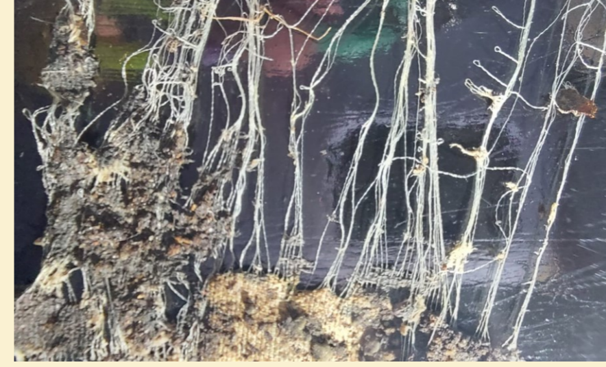
Şekil 4.3. 12. Hafta Sonunda Kompost İçerisinden Çıkarılan Kenevir Maske
