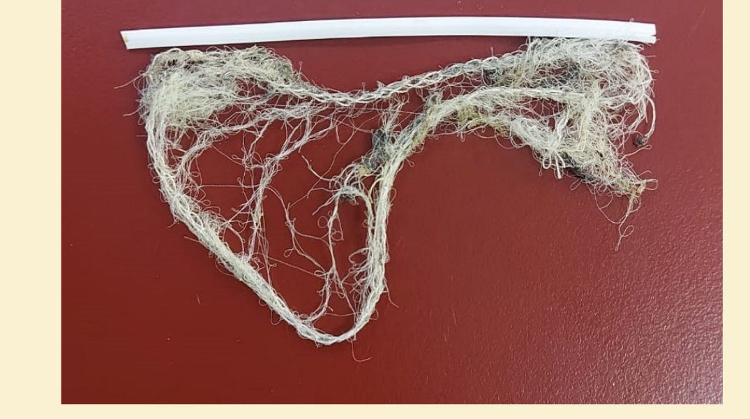
Şekil 5.4. 18. Hafta Sonunda Kompost İçerisinden Çıkarılan Pamuklu Maske
