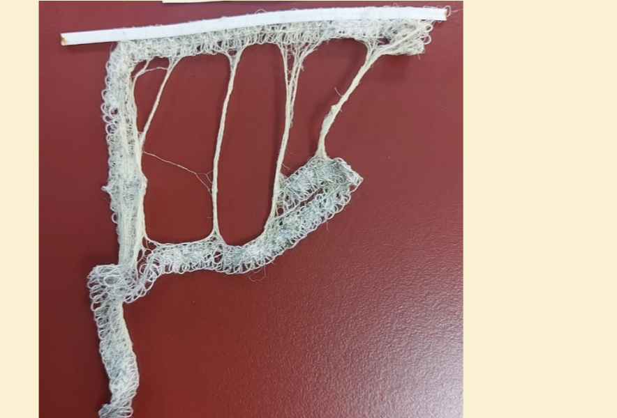
Şekil 5.3. 18. Hafta Sonunda Kompost İçerisinden Çıkarılan Kenevir Maske
