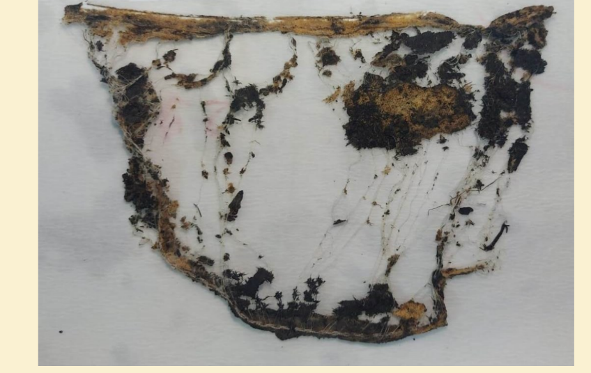
Şekil 4.4. 12. Hafta Sonunda Kompost İçerisinden Çıkarılan Pamuklu Maske
