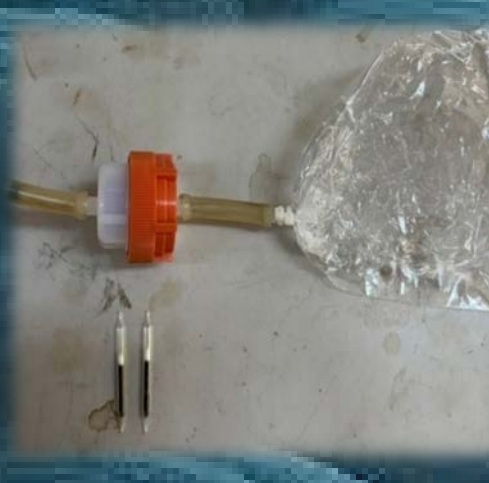
Şekil 9. UOB örneklemesi sistemi
