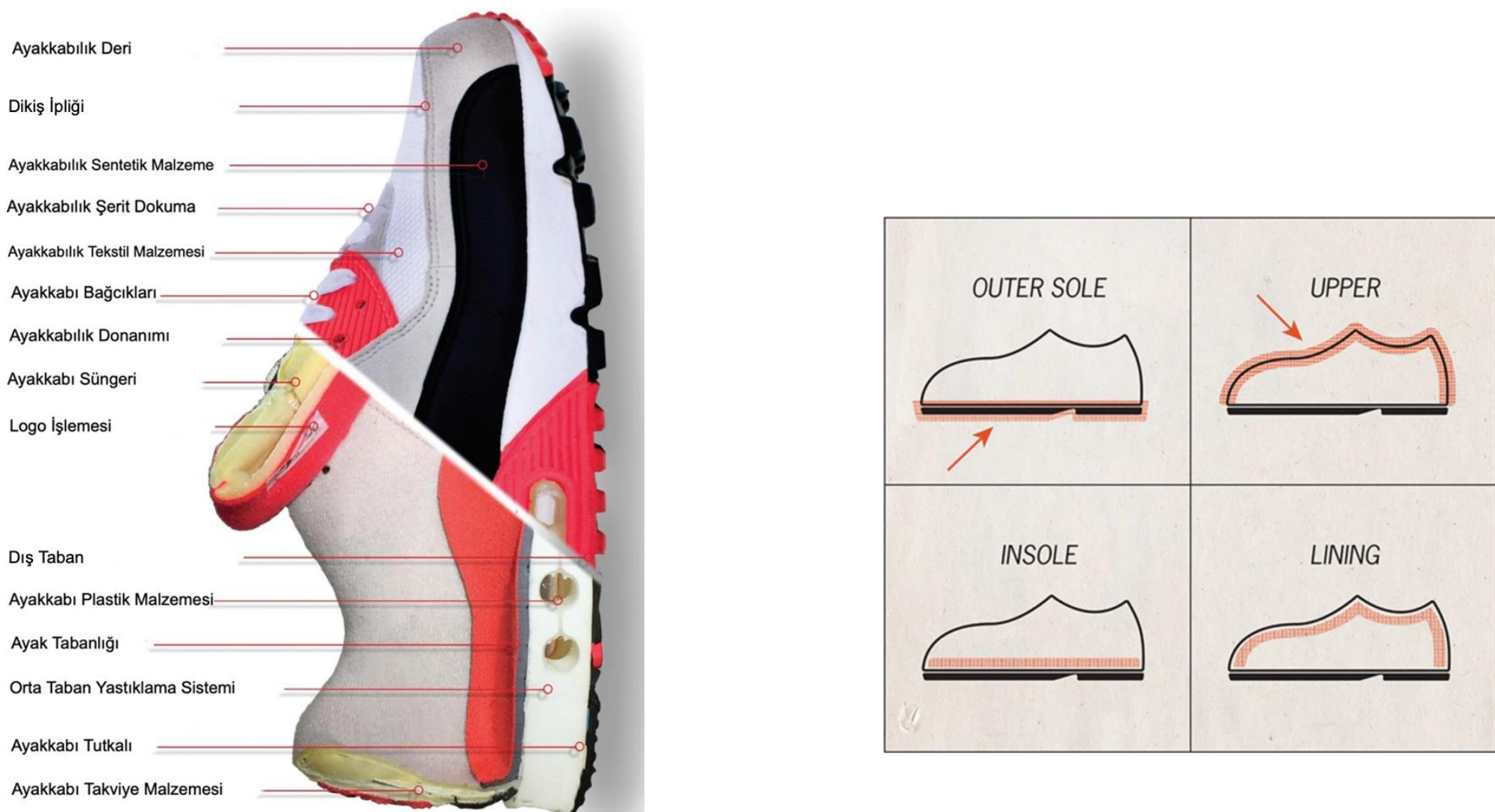
Şekil 1. Ayakkabıyı oluşturan malzemeler ve temel bileşenleri
